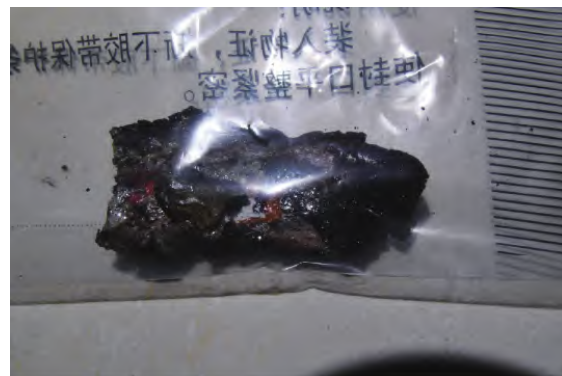
图7 塑料打火机熔融物残骸
