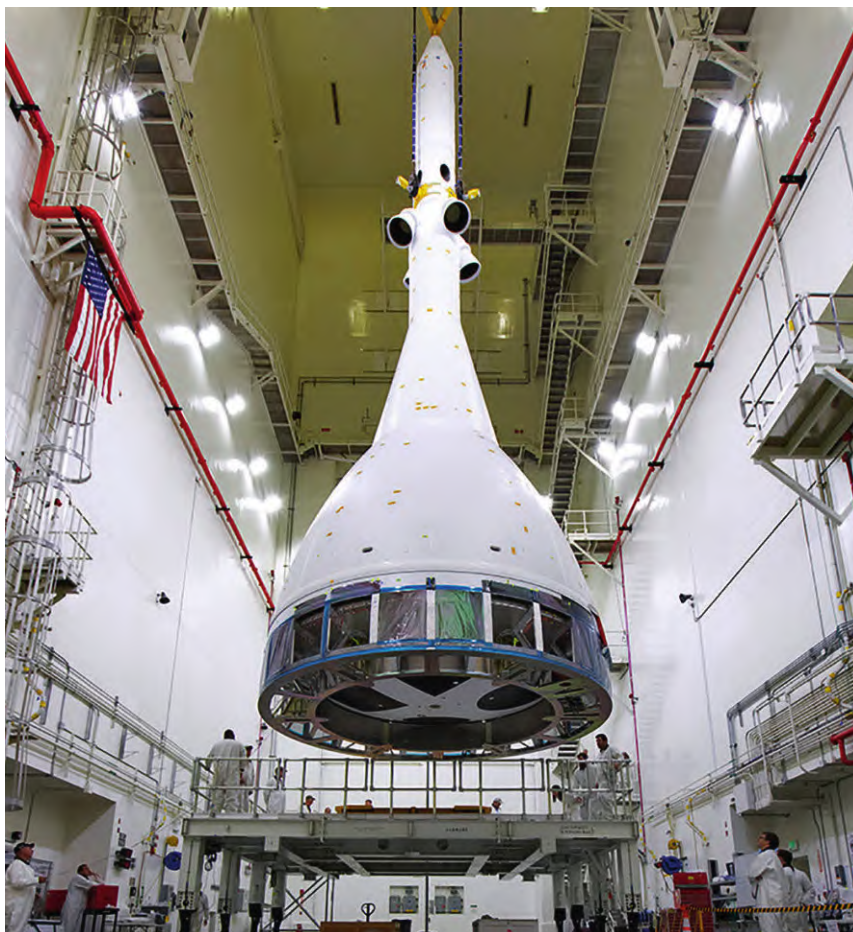
▲ 猎户座飞船的逃逸塔正在安装过程中
