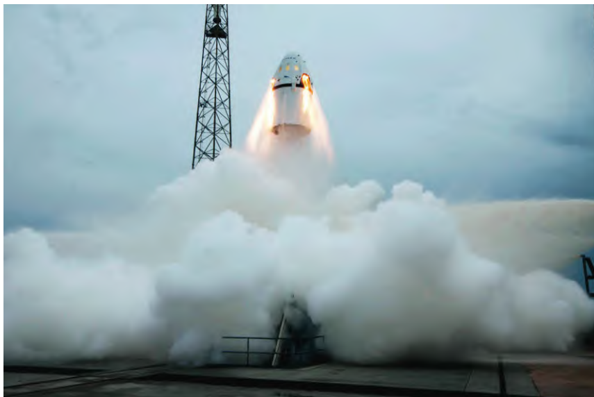
▲ 载人龙飞船的应急逃生地面实验
